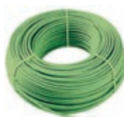
01890.C Cavo per sistemi KNX, 2x2x0,8 mm, con guaina in LSZH, Classe CPR Cca s1b d1 a1, conforme standard KNX, idoneo per installazione con cavi energia di I Categoria (U0 = 400 V), verde - 100 m
