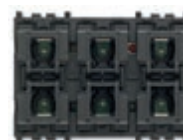
01487 6 pulsanti + attuatore 1 tapparella con orientamento lamelle, uscita a relè per motore cosφ 0,6 2 A 120- 240 V~ 50/60 Hz, individua- zione al buio a LED RGB con regolazione intensità, da completare con mezzi tasti intercambiabili - 3 moduli. Prof.tà: 37 mm
