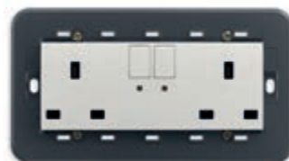
20222.L.N. 4 SICURY 2P+T 13 A, 2 interruttori 2P, completo di supporto. Prof.tà: 17,5 mm
