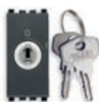
20082 Interruttore 2P 16 AX, chiave estraibile solo in posizione "O" (OFF). Prof.tà: 33,5 mm
