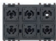
01485.AX 6 pulsanti programmabili, indi- viduazione al buio a LED RGB con regolazione di intensità, da completare con tasti intercam- biabili Flat - 3 moduli Prof.tà: 21,5 mm
