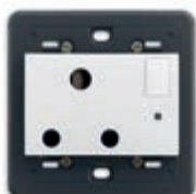
20217.L.B. 5 SICURY 2P+T 15 A, interruttore 2P, completo di supporto. Prof.tà: 25,5 mm
