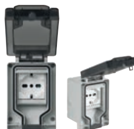
14962.U Presa SICURY 2P+T 16 A 250 V~ universale standard italiano P40 in contenitore da parete stagna IP66 a spina inserita, bianco - 2 moduli
