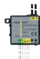
01477 Modulo 2 ingressi digitali programmabili per contatti privi di potenziale, 1 uscita comando luci a relé NO 10 A 120-230 V~ 50/60 Hz, 2 uscite per pilotaggio LED, domotica By-me
