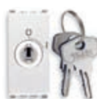
20082.B Interruttore 2P 16 AX, chiave estraibile solo in posizione "O" (OFF). Prof.tà: 33,5 mm
