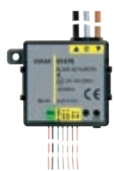
01476 Modulo 2 ingressi digitali programmabili per contatti privi di potenziale, 1 uscita per una tapparella con orientamento delle lamelle a relé per motore cosφ 0.6 2 A 120-230 V~, 2 uscite per pilotaggio LED, domotica By-me
