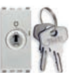
20082.N Interruttore 2P 16 AX, chiave estraibile solo in posizione "O" (OFF). Prof.tà: 33,5 mm
