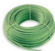
01890.E Cavo per sistemi KNX, 2x2x0,8 mm, con guaina in LSZH, Classe CPR Eca, conforme standard KNX, idoneo per installazione con cavi energia di I Categoria (U0 = 400 V), verde - 100 m
