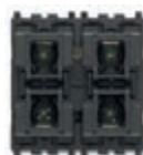
01489 4 pulsanti, 1 uscita 0/1-10 V SELV, 1 uscita a relè contatto NO 2A 120-240 V~ 50/60 Hz per ballast e LED driver, individuazione al buio a LED RGB con regolazione intensità, da completare con mezzi tasti intercambiabili - 2 moduli. Prof.tà: 37 mm
