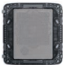
21588.B Diffusore passivo sonoro 8 \Omega 10 W, con supporto incorporato 8 moduli. Prof.tà: 48 mm
