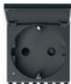
20208.C SICURY 2P+T 16 A, standard tedesco, con coperchio - 2 moduli. Prof.tà: 31,2 mm
