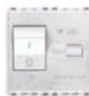
20411.16.B C 16, I_{\Delta n} 10 mA capacità d'interruzione 3000 A - 2 moduli. Prof.tà: 39 mm
