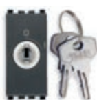
20086 Pulsante 2P NO 16 A, chiave estraibile solo in posizione "O" (OFF). Prof.tà: 33,5 mm
