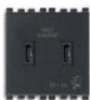
19295.CC 5 V 3 A, 2 USB C per totale 3 A, 120-240 V~ 50/60 Hz - 2 moduli. Prof.tà: 29 mm
