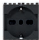
■ 19210.AB Presa SICURY 2P+T 16 A 250 V~- universale - 2 moduli. Prof.tà: 26 mm
