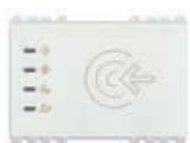
19457.B Lettore di carte a transponder per installazione all'esterno della stanza, standard KNX, 2 uscite a relè NO 4 A 24 V~, 2 ingressi, 12-24 V~ 50/60 Hz e 12-24 Vdc (SELV) - 3 moduli. Prof.tà: 37 mm. Fornito senza carta a transponder.
