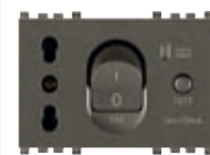
19283.M Bpresa 16 A P17/11 250 V~, 1P+N C 16 - 3 moduli. Prof.tà: 39,6 mm
