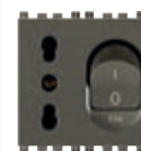
19273.M Bpresa 16 A P17/11 250 V~, 1P+N C 16 - 2 moduli. Prof.tà: 39,7 mm
