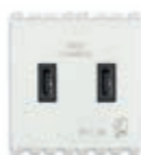
19295.CC.B 5 V 3 A, 2 USB C per totale 3 A, 120-240 V~ 50/60 Hz - 2 moduli. Prof.tà: 29 mm
