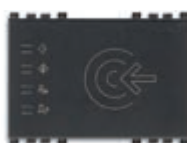
19457 Lettore di carte a transponder per installazione all'esterno della stanza, standard KNX, 2 uscite a relè NO 4 A 24 V~, 2 ingressi, 12-24 V~ 50/60 Hz e 12-24 Vdc (SELV) - 3 moduli. Prof.tà: 37 mm. Fornito senza carta a transponder.
