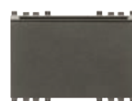
19453.M Lettore di carte a transponder con tasca verticale per installazione all'interno della stanza, standard KNX, 2 uscite a relè NO 4 A 24 V~, 2 ingressi, 12-24 V~ 50/60 Hz e 12-24 Vdc (SELV) - 3 moduli. Prof.tà: 37 mm
