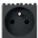
■ 19212.AB Presa SICURY 2P+T 16 A 250 V~- standard francese - 2 moduli. Prof.tà: 26 mm
