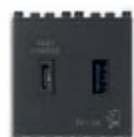
■ 19295.AC.AB Alimentatore USB 5 V 3 A, USB A+C per totale 3 A, 120-240 V~- 50/60 Hz. - 2 moduli. Prof.tà: 29,3 mm
