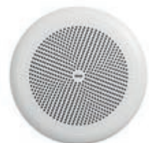
01906 Diffusore passivo sonoro IP55 8 Ω 30 W, installazione su pareti leggere e controsoffitto. Prof.tà: 70 mm
