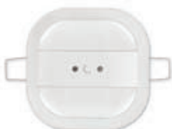
01527 Rivelatore con sensore di presenza IR a 360° per ON/OFF, regolazione costante dell'illuminamento, riscaldamento, climatizzazione, ventilazione in funzione di luminosità/movimento, 1 - 1000 Lux, standard KNX, installazione a soffitto. Dim. 80x80x45 mm
