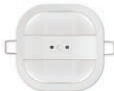
01529.1 Rivelatore con sensore di presenza IR a 360° per ON/OFF luci in funzione di luminosità/movimento, 1 - 1000 Lux, standard KNX, installazione a soffitto. Dim. 91x91x45 mm
