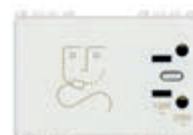
■ 19290.AB.B Presa per rasoi con trasformatore d'isolamento 20 VA, 230 V~ 50/60 Hz, uscite 230 V~ e 120 V~- 3 moduli. Prof.tà: 42 mm
