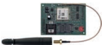
01706 Modulo trasmettitore/ricevitore GSM Dual Band GSM/GPRS 900/1800 MHz
