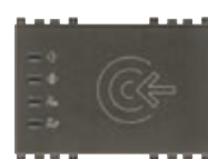
19457.M Lettore di carte a transponder per installazione all'esterno della stanza, standard KNX, 2 uscite a relè NO 4 A 24 V~, 2 ingressi, 12-24 V~ 50/60 Hz e 12-24 Vdc (SELV) - 3 moduli. Prof.tà: 37 mm. Fornito senza carta a transponder.
