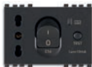
19283 Bpresa 16 A P17/11 250 V~, 1P+N C 16 - 3 moduli. Prof.tà: 39,6 mm
