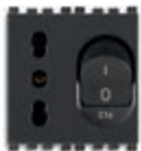
19273 Bpresa 16 A P17/11 250 V~, 1P+N C 16 - 2 moduli. Prof.tà: 39,7 mm
